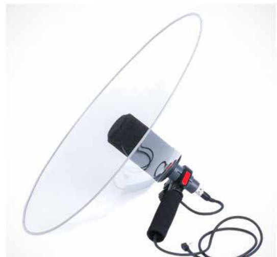
» Foto 4. Voorbeeld van een minder compacte uitrusting: een parabool reflector microfoon die nog moeten aangesloten worden op een opnametoestel. (Bron: www.telinga.com )
