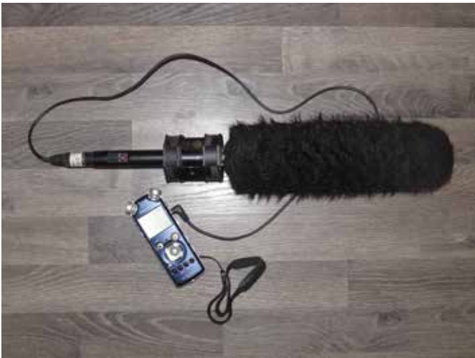
» Foto 3. Voorbeeld van een compacte uitrusting: een handformaat digitale recorder met een richtmicrofoon voorzien van windscherm en shock-absorber (Foto: Peter Boesman)
